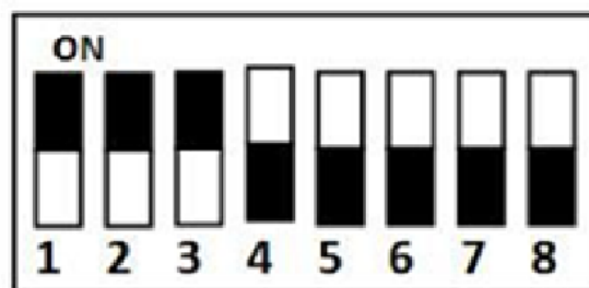
Adresa 7 - Dvere 4 vstupná čítačka
